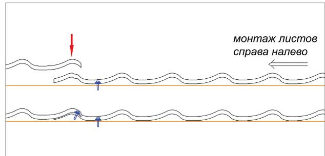
Причина такого утолщения понятна из рисунка. Для устранения такого утолщения нужно на одном из нижних листов слегка «выпрямить» капиллярную канавку ниже линии штамповки или срезать небольшой фрагмент угла, что незначительно усложняет монтаж.
