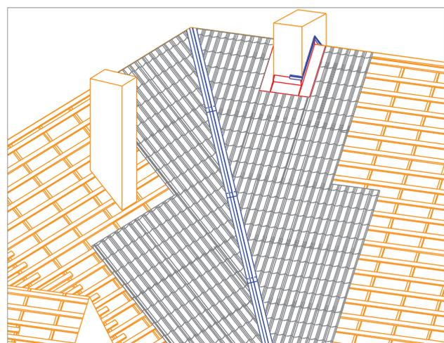
и течет по линии сгиба ендовы. Прошлогодние листья, попавшие на кровлю, также попадают под накладку ендовы и при достаточном зазоре между резаными краями металлочерепицы будут смыты водой вдоль планок ендовы.
