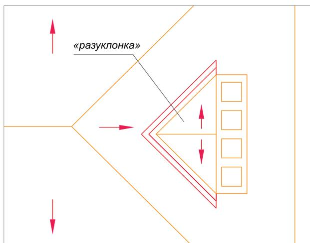
Кровельщик с хорошими навыками жестянщика найдет способ надежно провести воду даже мимо трубы, стоящей в ендове. Начинающим кровельщикам лучше не экспериментировать и пригласить на этот участок работы опытного жестянщика, например специалиста по фальцевым кровлям, или добиться переноса трубы из ендовы.
