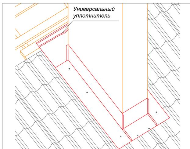
Соедините 3 детали фартука между собой и закрепите саморезами нижний фартук на металлочерепице.
