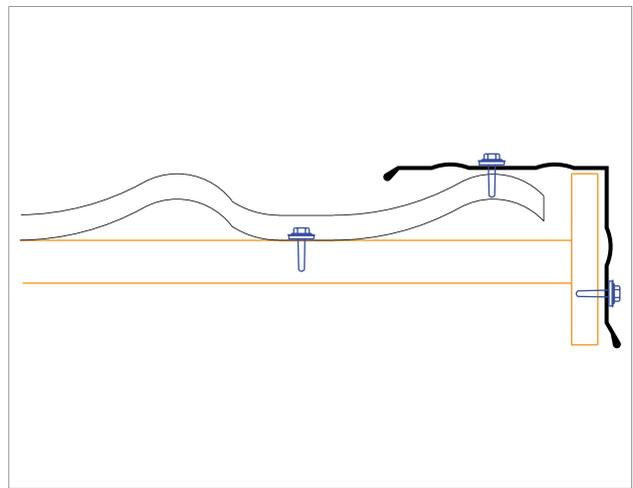
Если ширину ската не «подгоняли» под размер волны металлочерепицы, лист может подойти к одному из фронтонов нижней частью волны. При этом штатная фронтовая планка не накроет гребень. Откорректируйте, если это возможно, величину фронтового свеса или смонтируйте дополнительную страховочную кровельную планку, изготовленную специально для этого места. Смонтируйте, при необходимости, универсальный уплотнитель между страховочной кровельной планкой и листом металлочерепицы.
